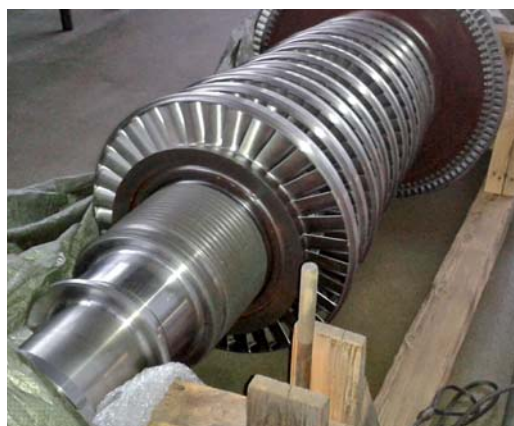
Rotor turbíny po rekonstrukci, na horních záběrech již usazený ve skříní.
